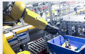
不定形品のバラ積みピッキ
